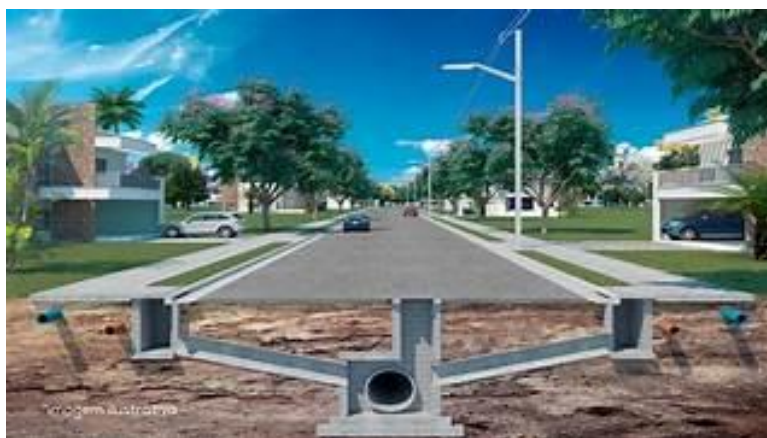
Figura 4 – Exemplo genérico de drenagem urbana.
