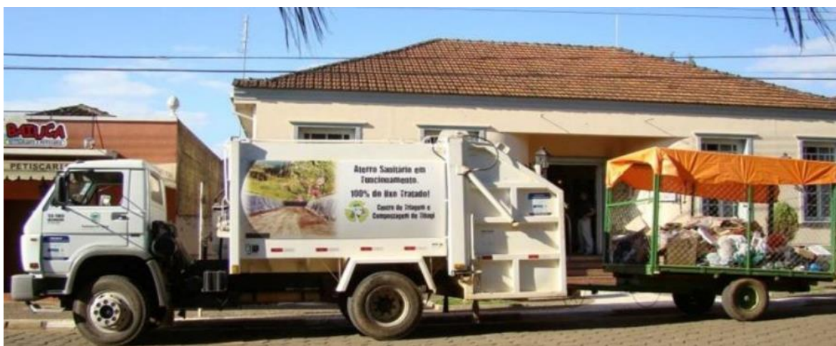
Figura 27: Caminhão coletor compactador adaptado para coleta de resíduos recicláveis Fonte: Ministério Público Estado do Paraná, 2012
